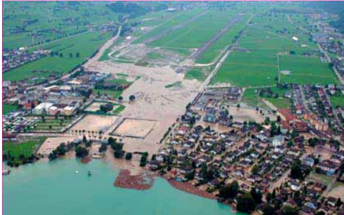
Beim Hochwasser vom August 2005 überfloss die Engelberger Aa in den Entlastungskorridor. Ein Teil von Ennetbürgen wurde überschwemmt. Sand und Schlamm lagerten sich in extrem grossen Mengen ab. In der Flachwasserzone im See wurden bis zu 60 Zentimeter Feinschlamm festgestellt. Die Unterwasserpflanzenbestände wurden vollständig überdeckt. Der Föhnsturm vom 19. Februar 2006 verlagerte einen grossen Teil der Ablagerungen in die Tiefe des Sees.
